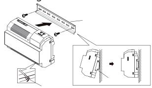
Schritt 1: Befestigen Sie die Hutschiene mit Schrauben an der Wand.
