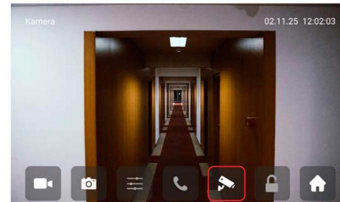
Das Betätigen von wechselt zwischen der Türstationkamera zur externen Kamera, sofern eine externe Kamera angeschlossen ist.
