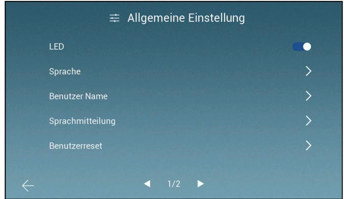
Um die LEDs am Monitor auszustellen, muss der Regler "LED" ausgestellt sein.
