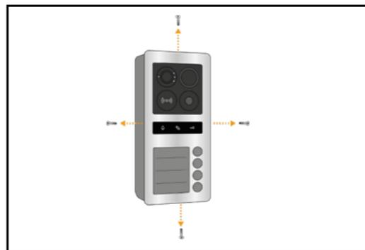
Entfernen Sie die Halterungsschrauben.
