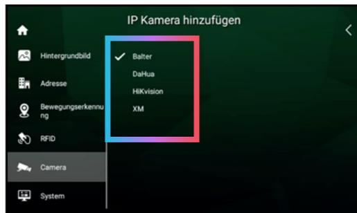
Wenn Sie eine BALTER Kamera anschließen, tippen Sie auf „Balter“. Wenn Sie eine NEOSTAR oder HiLook Kamera anschließen, tippen Sie auf „HiKvision“.
