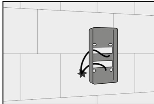
Führen Sie die Drähte durch die Aussparungen des Aufputzkastens.
