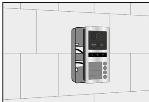
Verbinden Sie die Drähte mit der Türstation.
