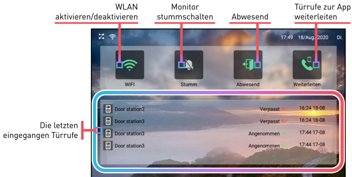
**WLAN aktivieren/deaktivieren:** Diese Funktion kann nur genutzt werden, wenn der Monitor bereits mit dem WLAN verbunden wurde (Siehe Seite 36).
