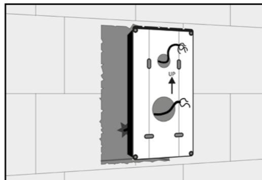
Führen Sie die Drähte durch die offenen Sollbruchstellen des Unterputzkastens.
