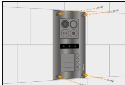
Setzen Sie die Türstation in den Unterputzkasten und befestigen Sie sie mit den Befestigungsschrauben.
