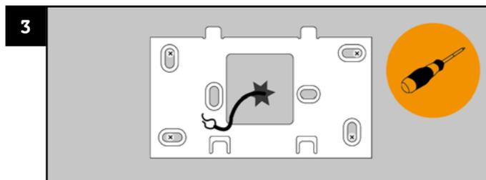
Befestigen Sie die Wandhalterung mit Dübeln und Schrauben an der Wand. Führen Sie die Drähte durch die dafür vorgesehene Aussparung der Wandhalterung.
