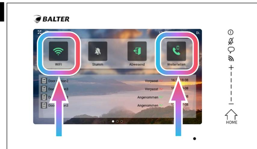
Die Anlage muss mit dem WLAN verbunden (siehe Seite 40) sein und die WLAN muss aktiviert sein (das WLAN-Symbol im Kontrollcenter muss grün dargestellt sein).
