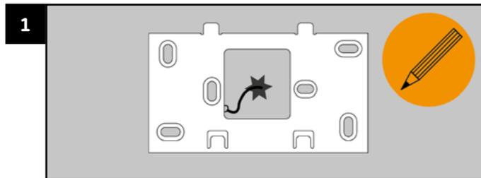
Markieren Sie Bohrlöcher mit Hilfe der Wandhalterung.
