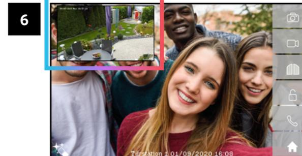
Im Live-Menü wird nun das Live-Bild der Kamera neben dem Livebild der Türstation angezeigt. Tippen Sie auf das Bild der Kamera, um es zu vergrößern.
