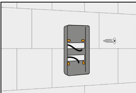
Befestigen Sie den Aufputzkasten mit geeigneten Mitteln.
