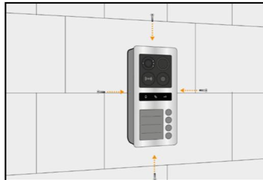
Befestigen Sie die Türstationen mit den Halterungsschrauben wieder am Aufputzkasten.
