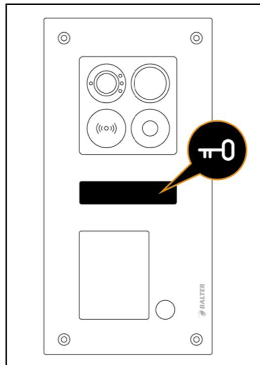
Wenn eine Karte hinzugefügt wurde, leuchtet das Schlüssel-Symbol in der Statusleiste der Türstation. Wiederholen Sie den Vorgang mit allen gewünschten Karten.
