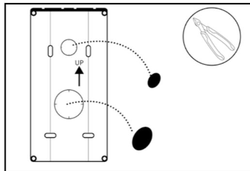
Entfernen Sie die Sollbruchstellen des Unterputzkastens
